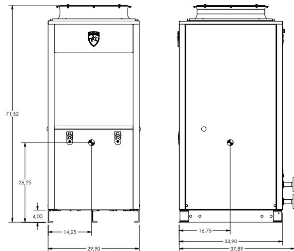
Figure 2-3 Centre de gravité de la thermopompe 140K
