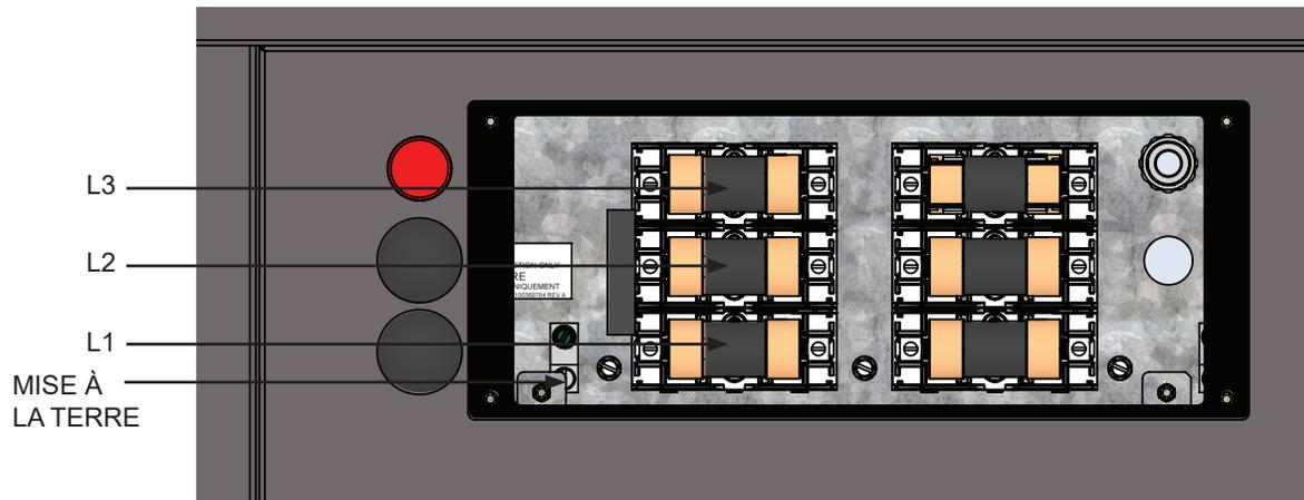
Figure 7-2 Câblage de la pompe
